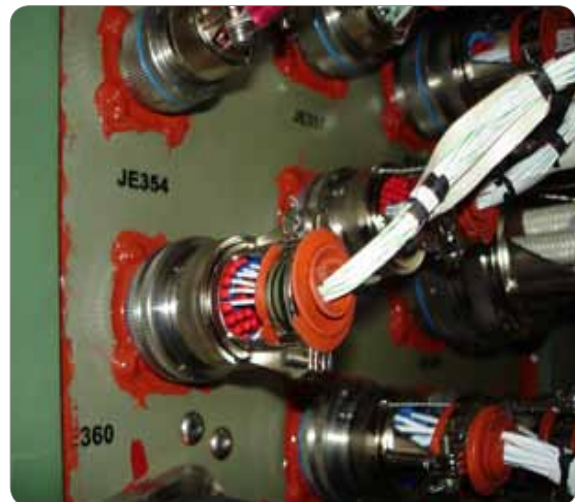
[그림 2-149] Backshells with strain relief
