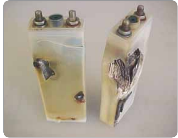
[그림 2-35] Thermal runaway damage
