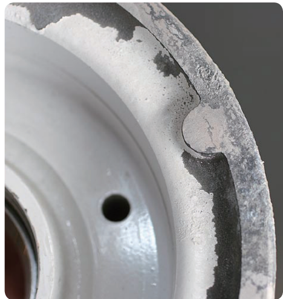
[그림 6-16] Magnesium corrosion
