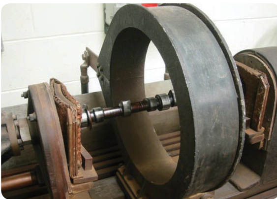
[그림 10-17] Longitudinal magnetization of crankshaft(Solenoid method)
