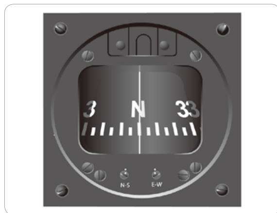
[그림 3-17] A magnetic compass
