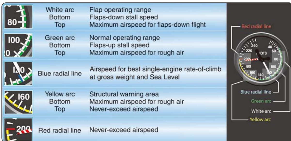
[그림 3-13] Color codes for an airspeed indicator
