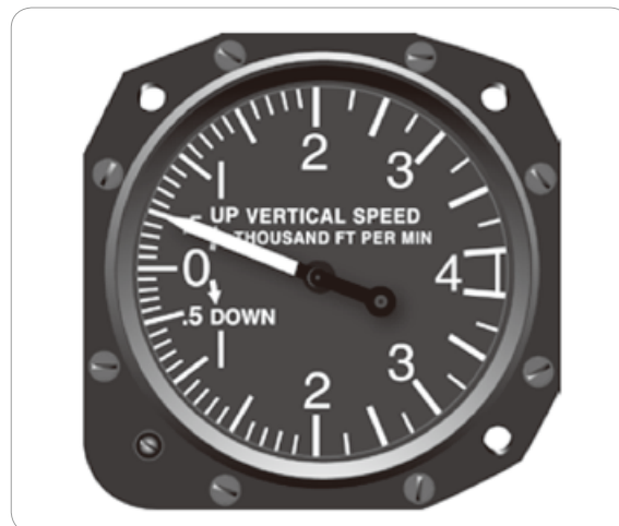
[그림 3-14] VSI 분당 1000 피트 단위로 상승, 강하를 표시
