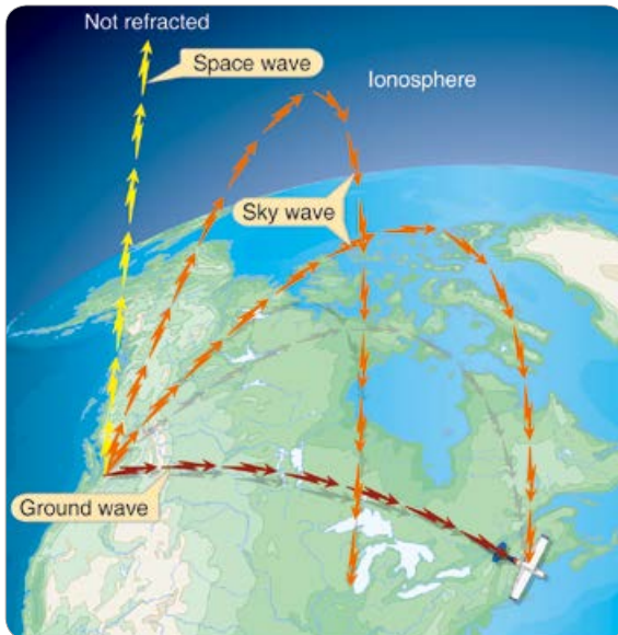
[그림 2-1] Ground, space, and sky wave propagation
